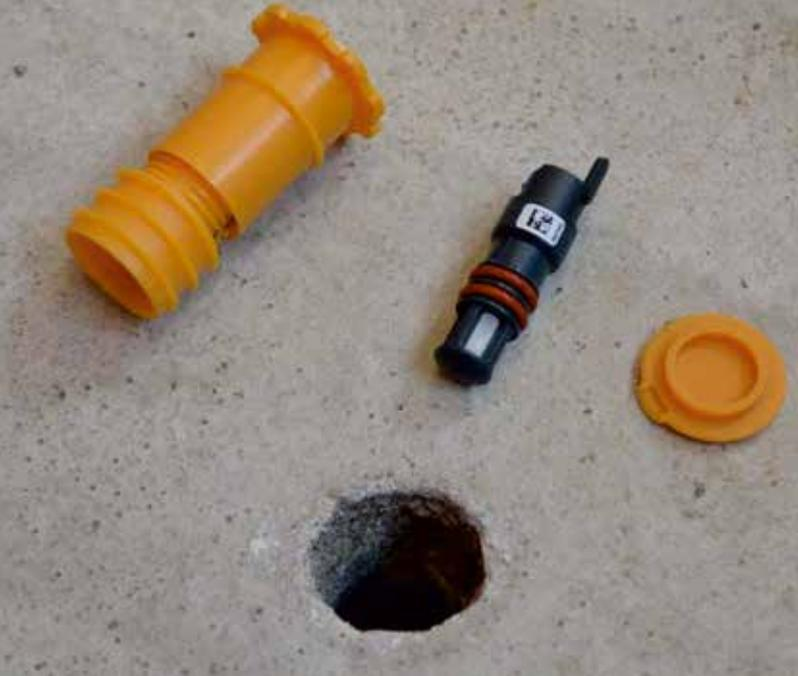
Abnehmbare Mini-Sensoren können zwischen zwei Terminen in der Messhülse verbleiben. Der Sensor wird durch eine Kappe vor Verschmutzung geschützt
