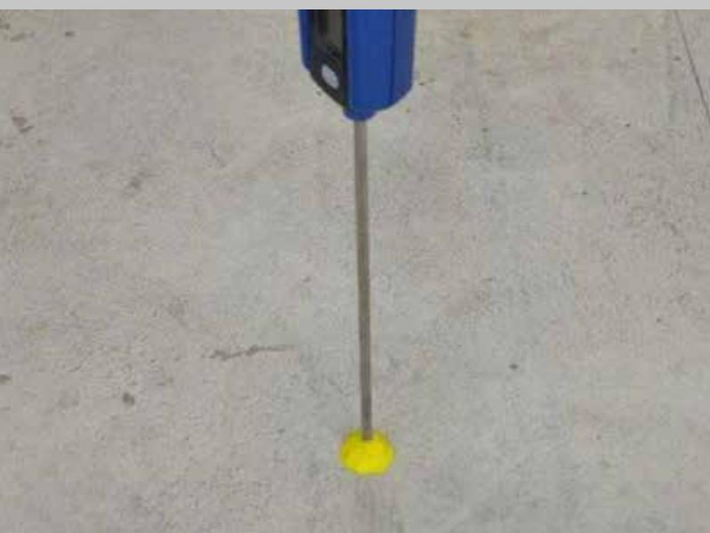
Messgeräte mit feststehenden Fühlern sind für derartige Messungen bei mehreren Messpunkten oder häufigen Wiederholungsmessungen unpraktisch. Die Messungen müssten nacheinander erfolgen, falls dem Anwender nur ein Gerät zur Verfügung steht. Weiterhin bestünde die Gefahr, dass die aus dem Estrich ragenden Geräte beschädigt würden.
