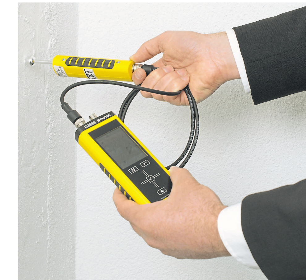
Mit einem Messgerät lässt sich die Feuchtigkeit in den Wänden bestimmen.
