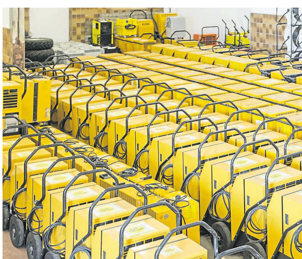
Ein Blick ins Lager: Hier stehen die Hilfsmittel für die Bautrocknung.
